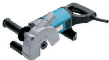
Corta hasta 35 mm de ancho y 45 mm de profundidad en hormigón con sus 1800 W de potencia y doble disco de diamante
